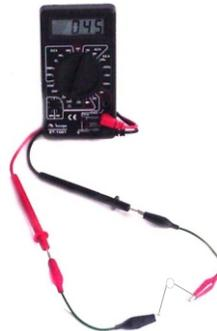
1 - Monte o circuito como mostra a foto. O ohmímetro deverá estar em uma escala ligeiramente maior que  $100 \Omega$ . Meça o valor da resistência do NTC.
