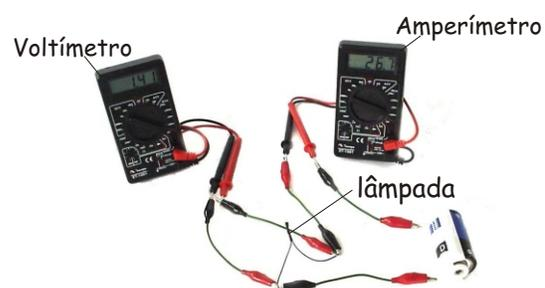
**2** - Monte o mesmo circuito, mas com duas pilhas. Meça o valor da corrente elétrica e da tensão.
