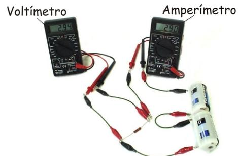
**3** - Monte o mesmo circuito com três pilhas. Meça o valor da corrente elétrica e da tensão. Em seguida coloque todos os resultados obtidos em uma tabela e observe a relação existente entre os valores da tensão e da corrente elétrica.
